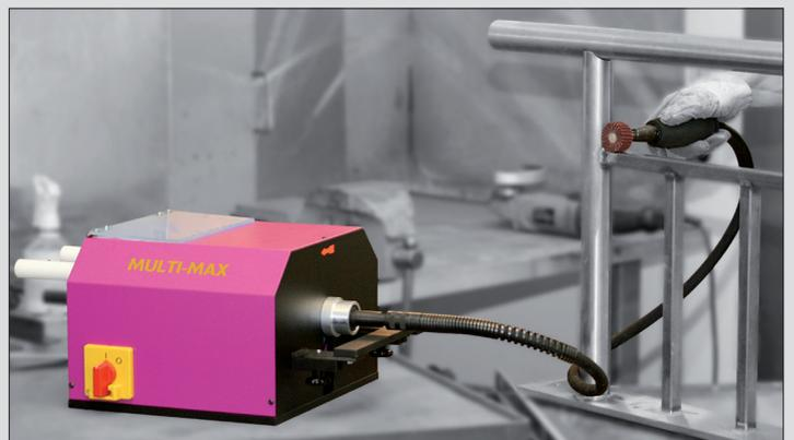
Sie haben mit dem Kauf Ihrer biegsamen Welle eine gute Wahl getroffen! Mit der neu entwickelten biegsamen Antriebswelle, der robusten 7 mm-Seele und dem andockbaren M14-Gewinde lässt sich der Hochleistungs-Winkelschleifer VARILEX® WSF 1800 von Eisenblätter zum Profi-Antriebsmotor aufrüsten. Die biegsame Welle ist auch mit sämtlichen anderen VARILEX® Maschinen und dem stationären Vielzweckschleifer MULTI-MAX kompatibel. Verwendet werden können alle 6 mm Schaftwerkzeuge bis Ø 60 mm .
